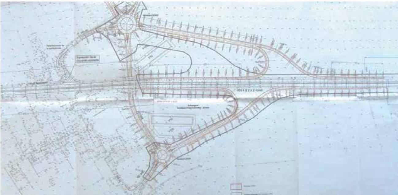
Ci-dessus, le plan modifié de l'échangeur suite aux nouvelles normes. Les voies d'accès côté nord débordent largement du couloir exproprié. Le côté sud est conforme au projet initial.
